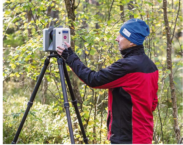
Allan Sims katsetamas uusimat tehnikat – maapealset laserskannerit
