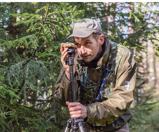
Puu asimuudi määramine täppiskompassiga
